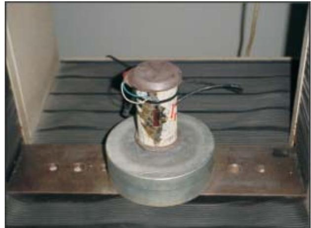
FIGURA 7. Ensaio de Módulo de Elasticidade.
