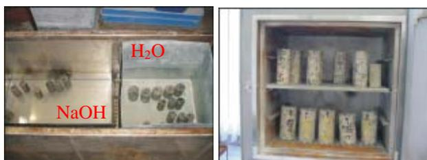
FIGURA 3 - Corpos de prova imersos em solução de NaOH, água e estufa a temperatura de 80°C
