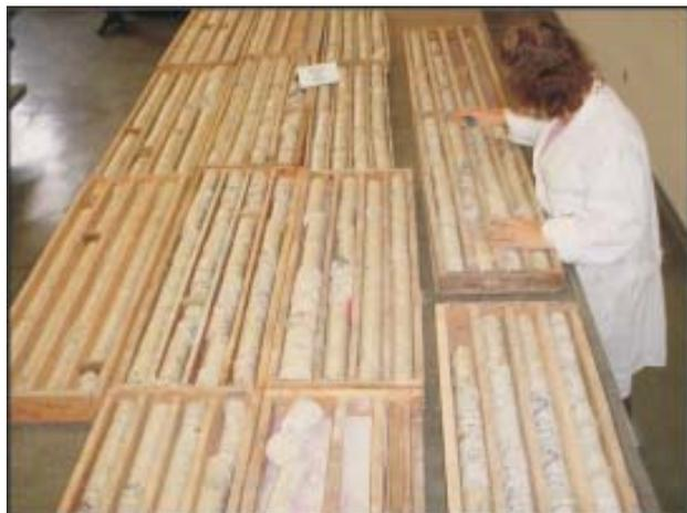
FIGURA 2 - Corpos de prova extraídos e marcação dos mesmos.
