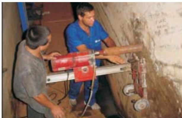
FIGURA 1 - Extração de corpos de prova.
