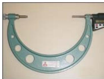
FIGURA 4 - Micrômetro adaptado com leitura digital.
