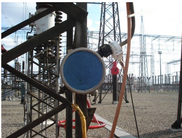
Figura 9. TC de alta frequência aplicado ao condutor de aterramento do pára-raios da fase AZ - LTA GUA-NOD.
