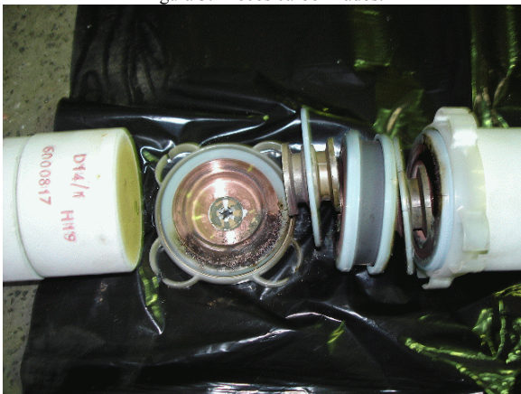
Figura 4. Sinais de ocorrência de descargas no centelhador .
