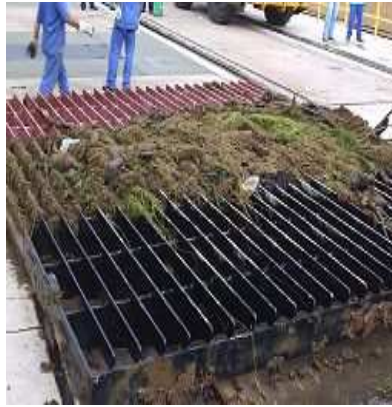
Figura 11 – Grade 3 A com os esquemas de pintura E 1 e E 3 (vermelho e preto) sem bioincrustação
