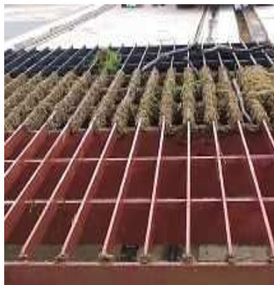
Figura 12 – Grade 3 F com os esquemas de pintura E 1 e E 3 (vermelho e preto) sem bioincrustação
