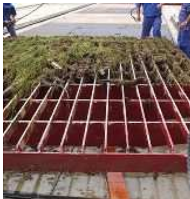
Figura 9 – Grade 4 F com o esquema de pintura E 4 (vermelho) sem bioincrustação
