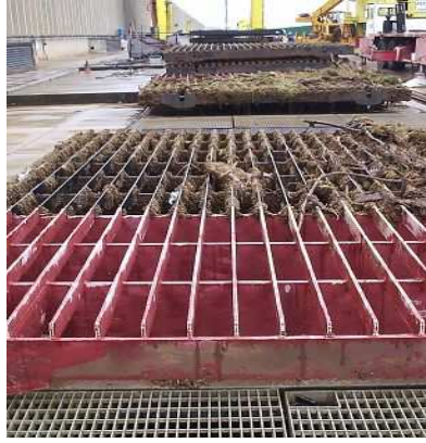
Figura 10 – Grade 4 A com o esquema de pintura E4 (vermelho) sem bioincrustação
