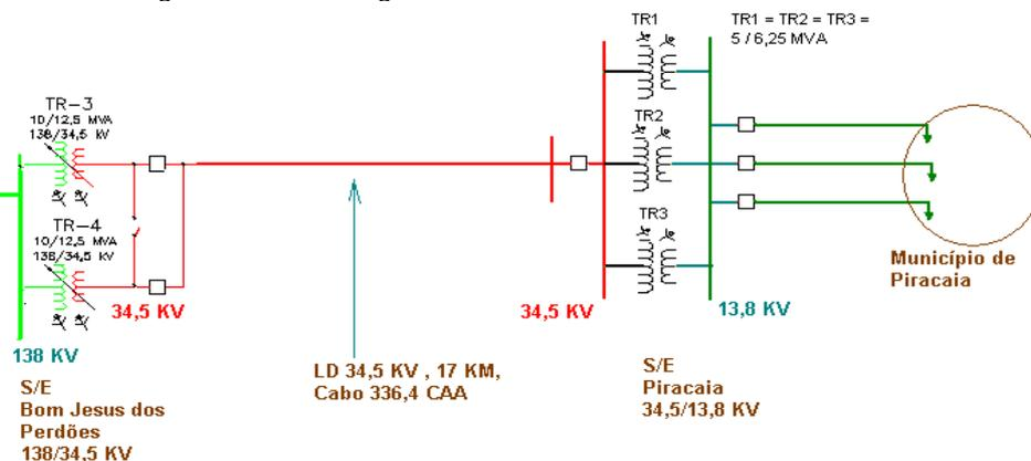
Figura 4 – Diagrama unifilar simplificado das subestações BJP e Piracaia
