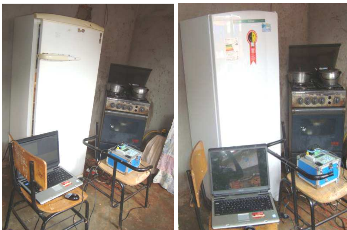
Figura 6 – (a) Medição de Geladeira antiga em campo utilizando o analisador de energia MARH21; (b) Medição de Geladeira SELO PROCEL em campo utilizando o analisador de energia MARH21.
