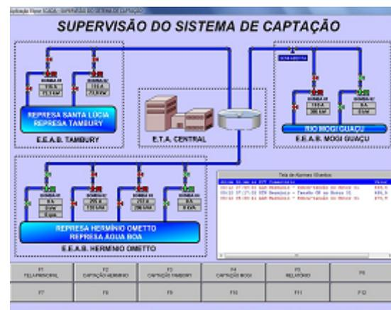
Figuras 11 e 12 – Tela do sistema supervisor da Captação Tambury e Tela do sistema supervisor que mostra a ligação das captações com a ETA
