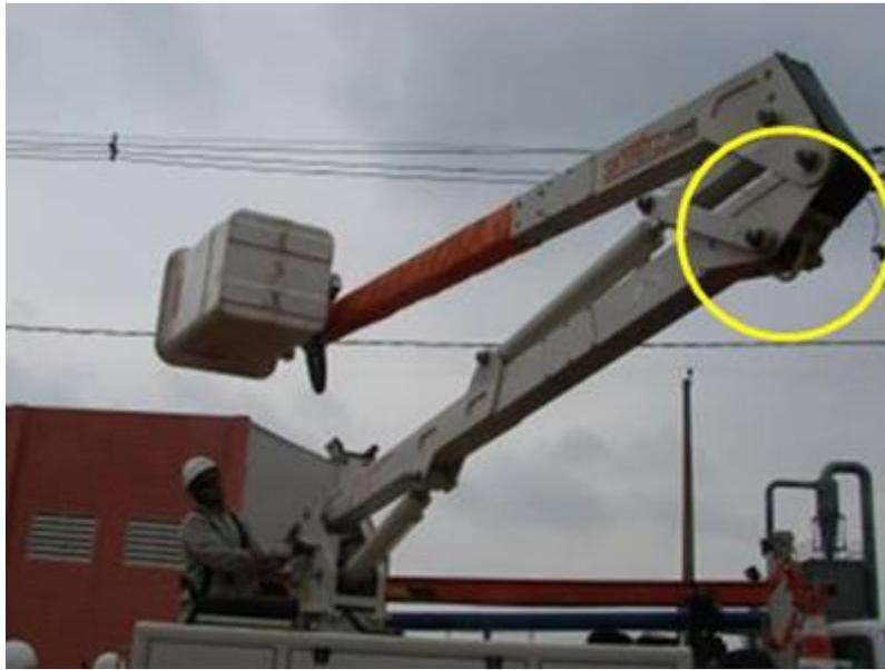
**Figura 1 – Local de instalação do gancho para içamento dos transformadores.**
