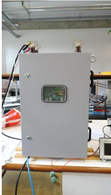
Fig. 2. Foto do regulador de tensão monofásico (externa).
