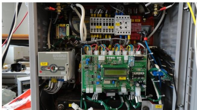
Fig. 1. Foto do regulador de tensão monofásico (interna).
