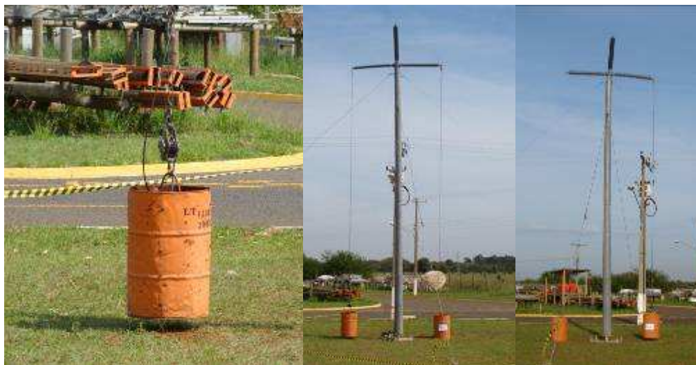
Foto 04: Experiência para testar a resistência mecânica da estrutura.
