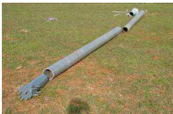
Foto 01: Base metálica articulada, poste de resina poliuretana e suporte de conexão para isoladores.
