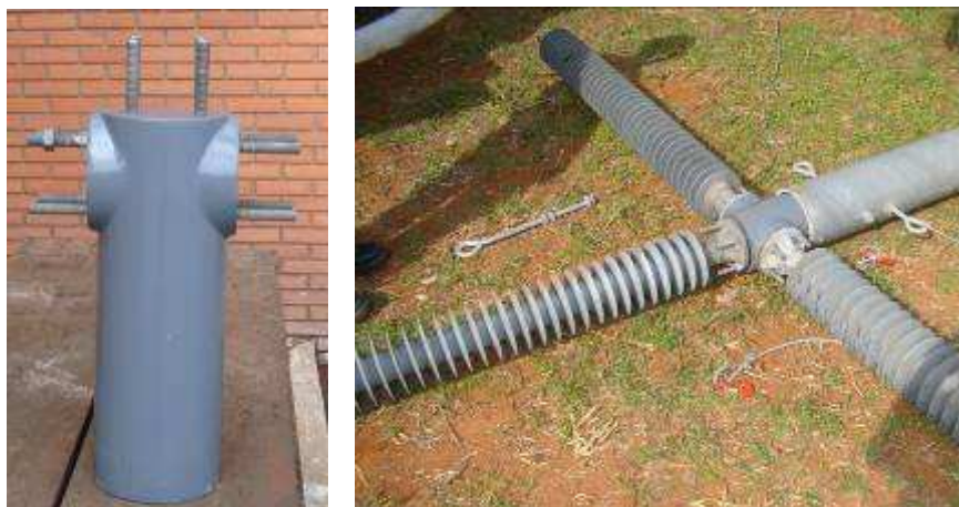
Foto 03 : Suporte para conexão com três isoladores polimérico de 138 kV.
