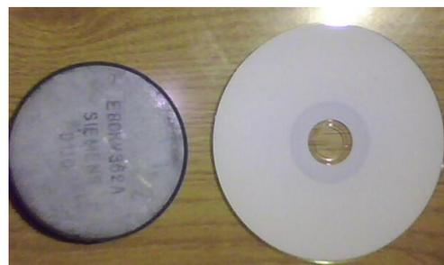
Fig. 9. Fotografia do varistor modelado para os estudos de TRT.
