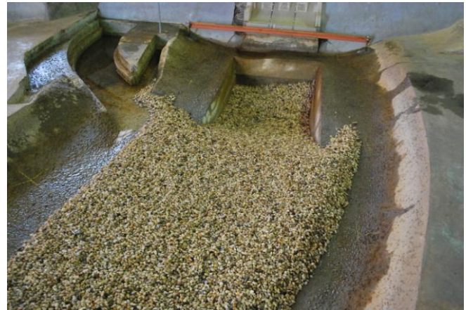
Figura 15 - Fossa de erosão formada após ensaio da Alternativa 9 com a vazão decamilenar.
