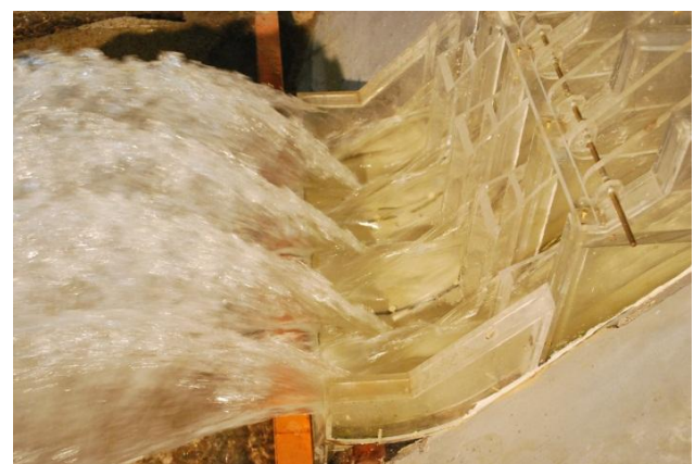
Figura 9 - Aspecto do jato dos ensaios utilizando pilares alargados.
