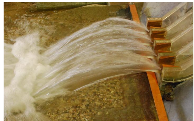
Figura 8 - Aspecto do jato dos ensaios utilizando defletores em fenda.
