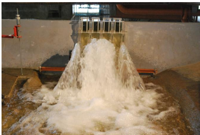
Figura 10 – Aspecto transversal do jato dos ensaios utilizando pilares alargados.
