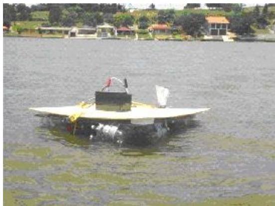
Figura 14. Sistema de plataforma flutuante utilizado na extração de metano instalado no ponto P4 no reservatório de Alagados.
