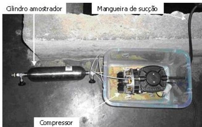
Figura 12. Sistema montado para coleta de gases no canal de fuga da UHE GPS.
