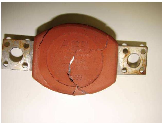
Foto 6 – Explosão de varistor de ZnO devido a alta energia do surto de tensão.
