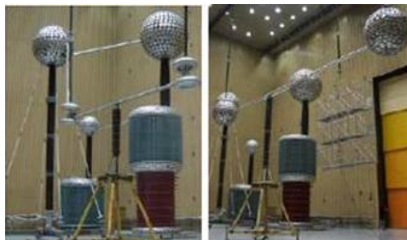
Figura A.1 – Arranjos dos ensaios: uma seção (ensaio a seco) e isolador completo sob chuva
