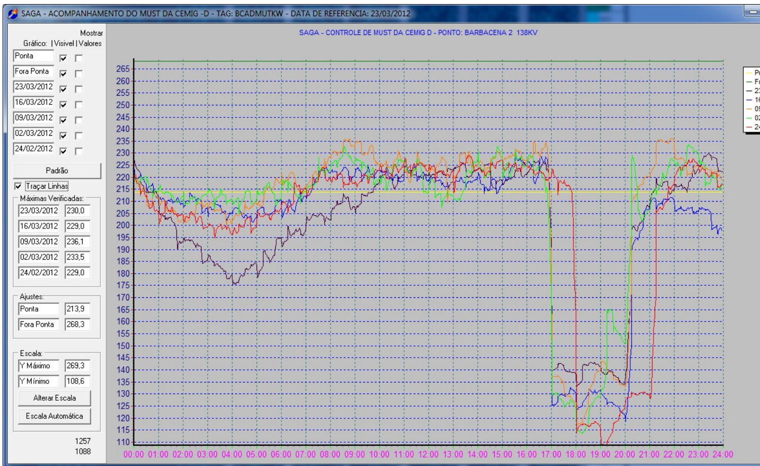
(Figura 5- Exemplo da Ferramenta gráfica para acompanhamento histórico ou em Tempo Real dos valores de potência ativa com resolução de um minuto e histórico de cinco semanas)
