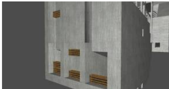
Figura 9 – Colocação de Stop-Logs da Jusante
