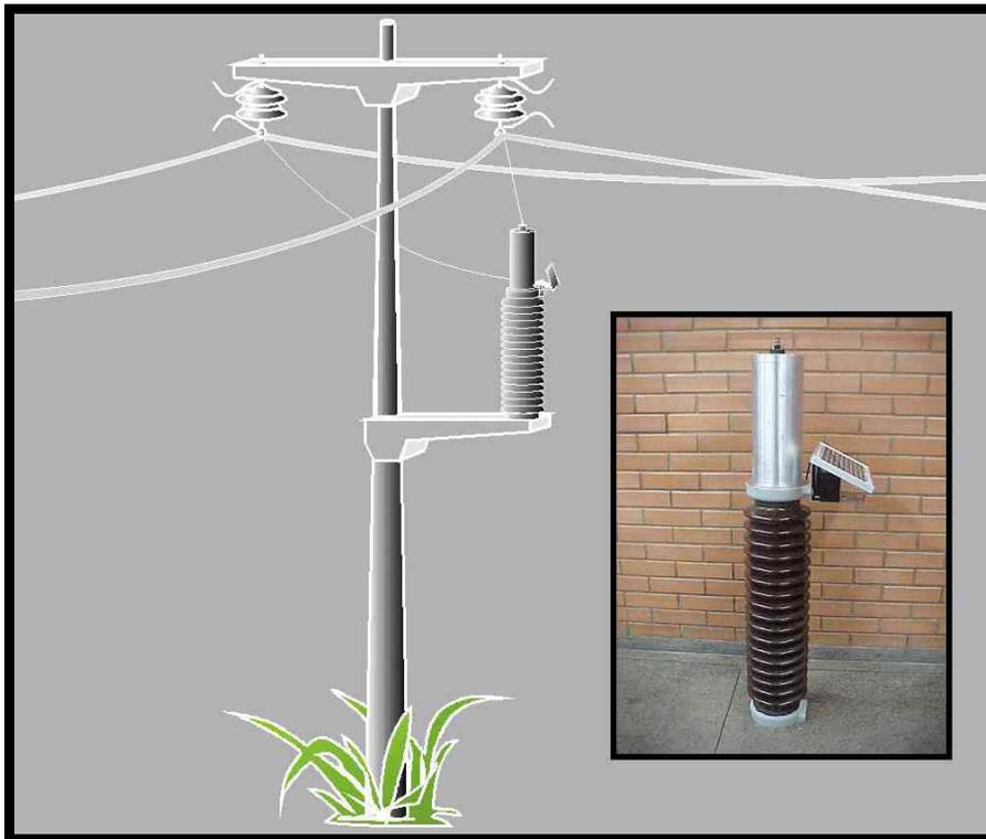
Figura 13: Instrumentação instalada nas linhas dos eletrodos de aterramento.
