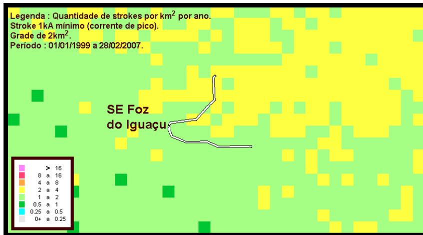
Figura 7: Densidade de descargas atmosféricas (strokes) na região das linhas dos eletrodos de aterramento da SE Foz do Iguaçu.
