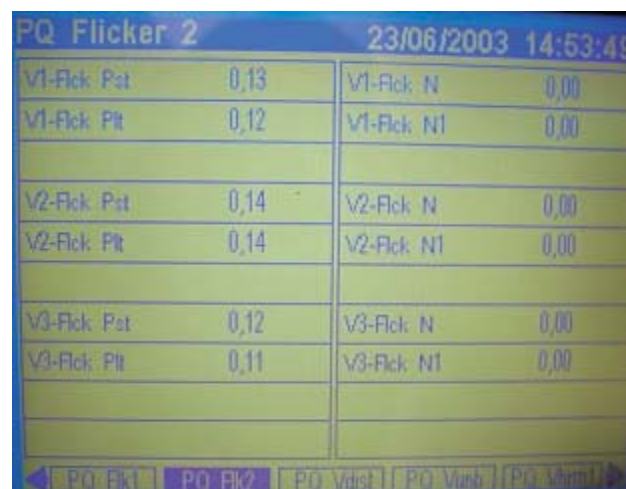
FIGURA 7. Medições de níveis de emissão de flicker Pst e Plt
