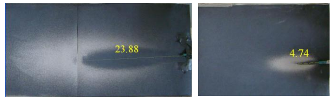
Figura 6. Distância (em mm) alcançada pelo jato de partículas com silo do alimentador modelo PM-PF-10 fechado (à esquerda) e aberto (à direita), sob a mesma regulagem de vazão de gás (5 l/min, Ar)
