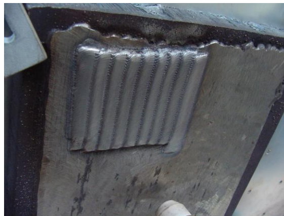
Figura 24. Revestimento soldado automaticamente durante o treinamento com o pessoal da Tractebel nas dependências do LABSOLDA – Posição sobre-cabeça
