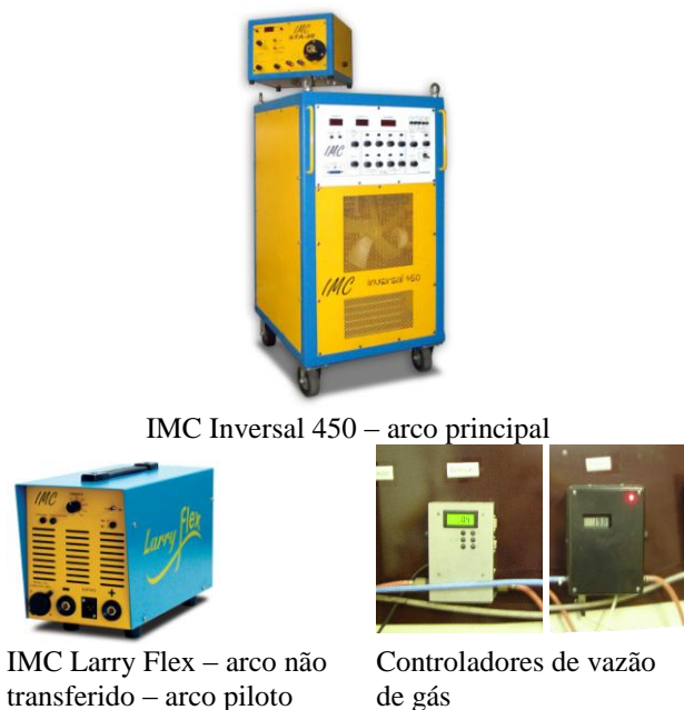
Figura 14. Componentes da bancada de ensaios PTA-P em laboratório
