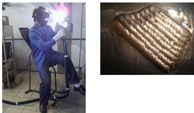
Figura 25. Revestimento manual realizado por técnico da Tractebel Energia, com um dia de treinamento
