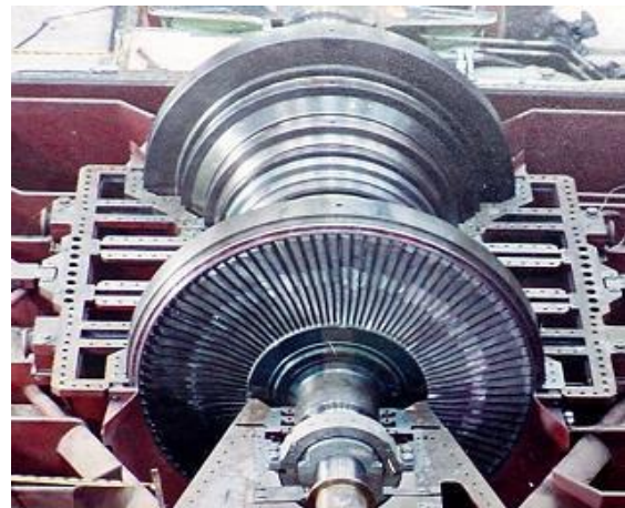
Figura 2. Vista da turbina de baixa pressão.
