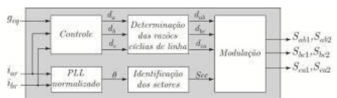
Figura 10. Estratégia de sincronismo, modulação e controle das correntes do GSIP pelo retificador PWM trifásico unidirecional.
