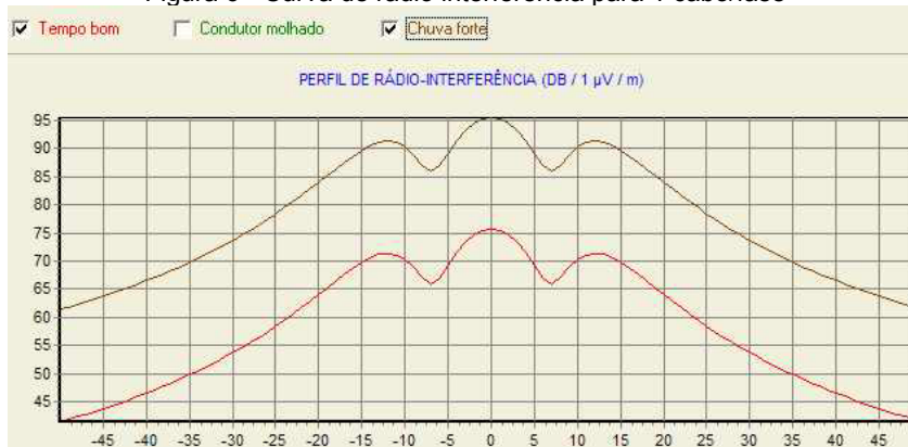
Figura 7 - Curva de rádio interferência para 2 cabos/fase
