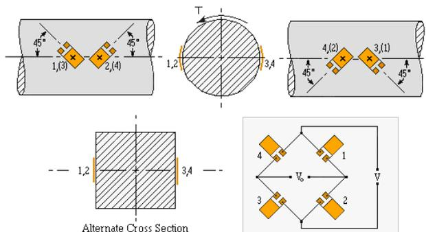
Figura 01: Esquema da instalação de extensômetros.
