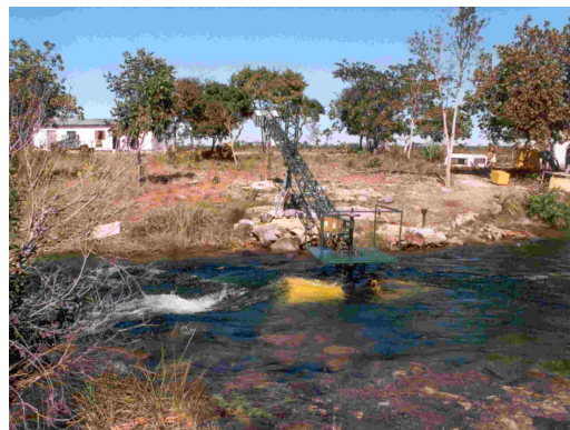
FIGURA 2 – Turbina Hidrocínética Geração I (diâmetro 800 mm e 700 W) e Geração II (diâmetro de 1200 mm e 1800 W, custo de R$ 15.000,00), Respectivamente (Els et al – 2005).
