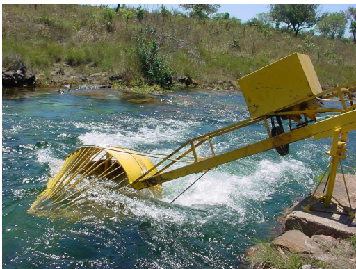
FIGURA 2 – Turbina Hidrocínética Geração I (diâmetro 800 mm e 700 W) e Geração II (diâmetro de 1200 mm e 1800 W, custo de R$ 15.000,00), Respectivamente (Els et al – 2005).
