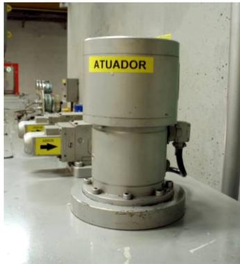
Figura 3 – Válvula atuadora, modelo TR-10, fabricada pela empresa Neyrpc (Eletronorte – UHE de Tucuruí).
