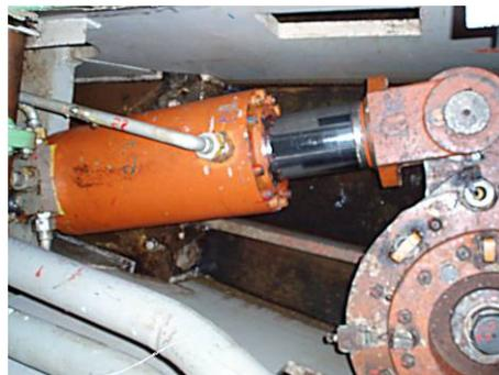
Figura 5 – Servo-motor que aciona as pás do distribuidor (Eletronorte – UHE de Tucuruí).
