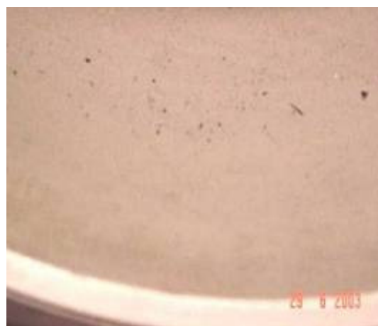
FIGURA 10 – Partículas na parte inferior do invólucro
