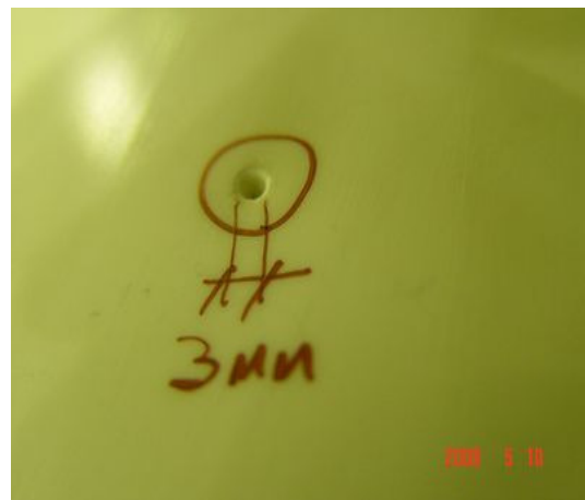
FIGURA 19 – Bolha de 3mm no isolador
