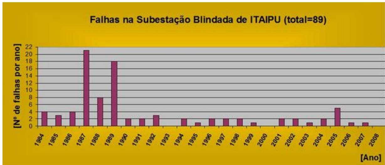
FIGURA 1 – Falhas por ano na SIG 500kV de Itaipu
