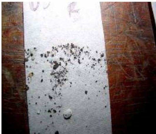
FIGURA 14 – Partículas metálicas e teflon
