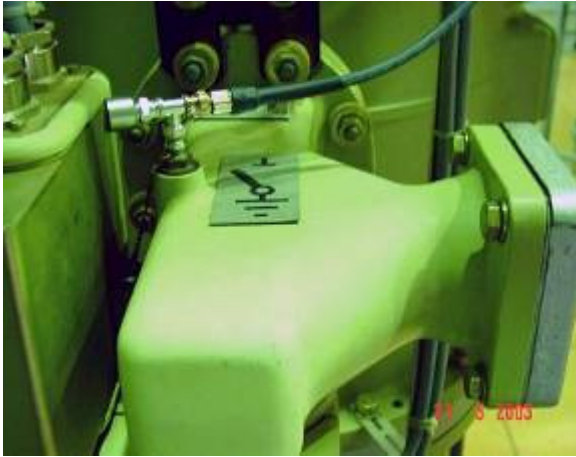
FIGURA 4 – Conexão ao sensor com um BNC tipo "T"
