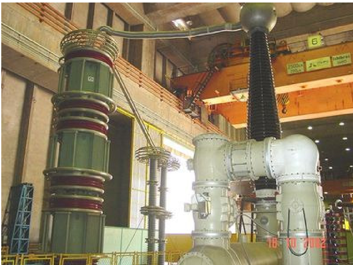
FIGURA 2 – Mini-SIG para prototipação com inserção de defeitos e aplicação de tensão
