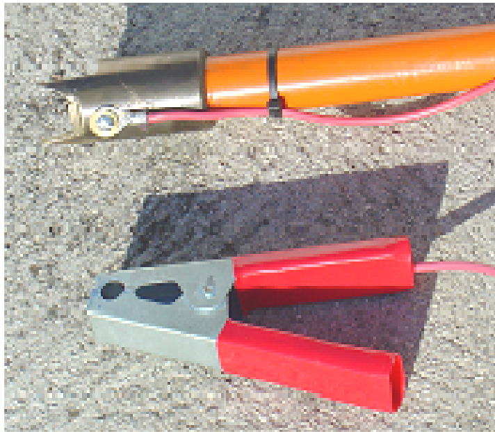
Imagem 6 – Detalhe dos terminais do cabo de medição
