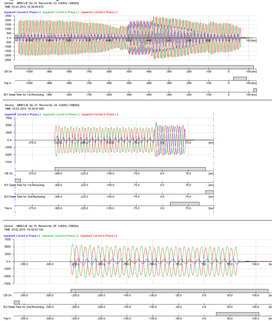
Figura 9 Oscilografia colhida de um relé mostrando faltas evolutivas no sistema
