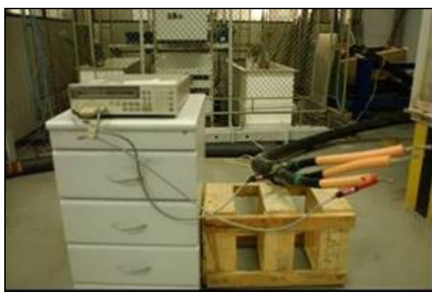
Figura 1. Arranjo experimental para medida de resistência de isolamento.
