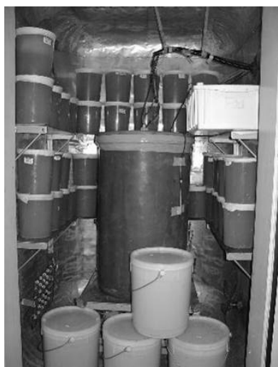
Figura 1 – Calorímetro adiabático adaptado para determinação das leis de evolução com o grau de hidratação.
