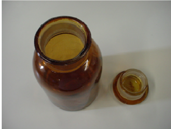
Figura 1 - Exemplo de um frasco de boca larga (capacidade de 1000 ml), com tampa esmerilhada.
