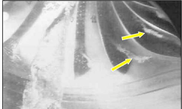
FIGURA 8 – Vórtices inter-pás no rotor não alterado de Três Irmãos
