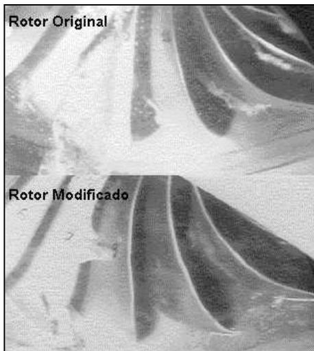
FIGURA 19 – Escoamento no rotor original e modificado no ensaio de modelo
