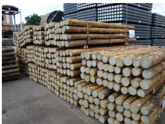
Fotos 7 e 8 – Estoque de cruzetas roliças de eucalipto, produzidas a partir de clones da espécie camaldulensis e instalação típica com chaves fusível, respectivamente.
