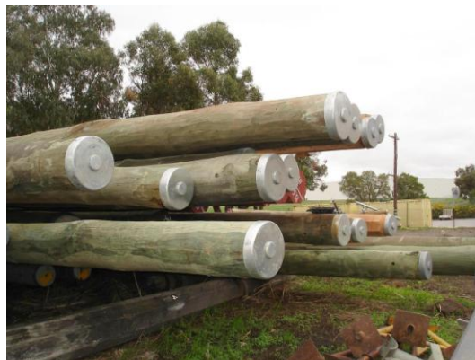
Fotos 3 e 4 – Topo de poste deteriorado e cobertura de topo utilizada na Austrália.
