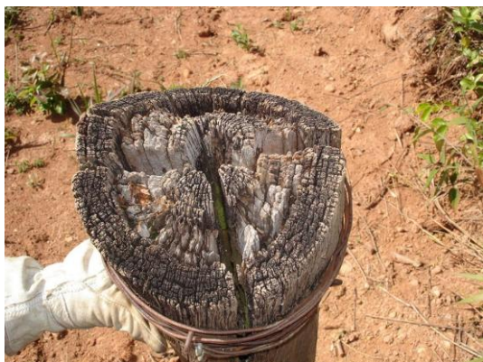
Fotos 3 e 4 – Topo de poste deteriorado e cobertura de topo utilizada na Austrália.
