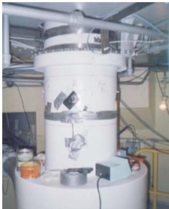
FIGURA 3 - Extensômetros instalados e preparados para a conexão com o equipamento de telemetria.
