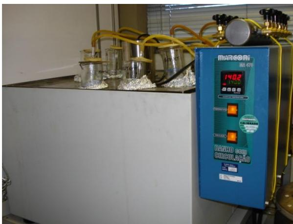
**Figura 8.** Banho termostabilizado a 140 °C para simulação de envelhecimento acelerado em OVIs com borbulhamento de oxigênio.
