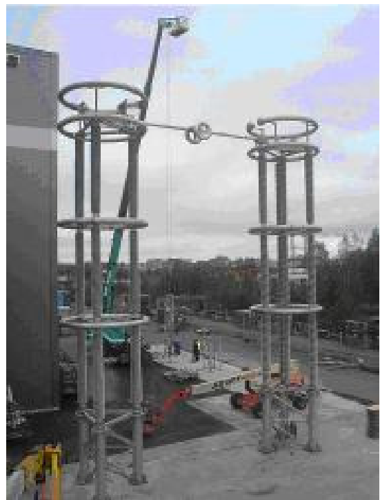
FIGURA 5 Conjunto de manobra de CC: Chave de by-pass (esquerda) e seccionador de CC em fase de testes de longo prazo (direita)
