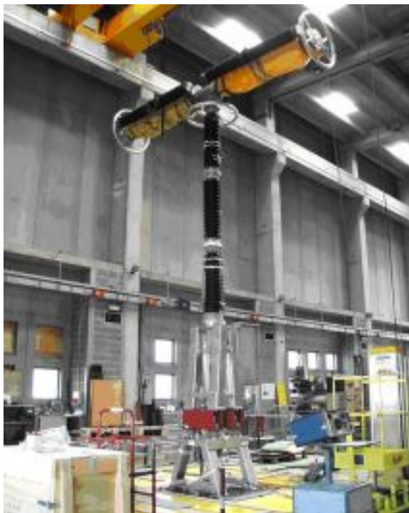
FIGURA 5 Conjunto de manobra de CC: Chave de by-pass (esquerda) e seccionador de CC em fase de testes de longo prazo (direita)
