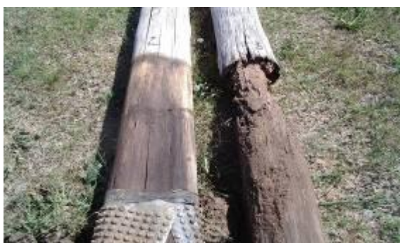
Figura 12 – Imagens de dois mourões com (esquerda) e sem (direita) retratamento externo ( Bioguard ) retirados da Área controlada de Barreto no final do experimento (nov/2005).
