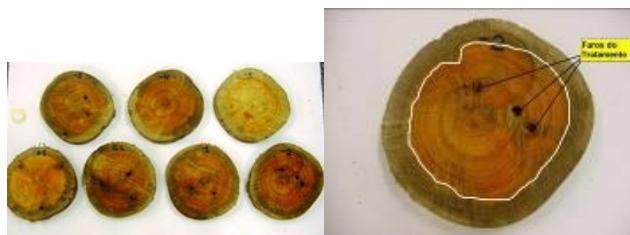
Figura 9 – Exemplo da análise colorimétrica para identificar a presença do Boro em madeira tratada internamente (Polesaver).
