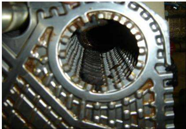
Figura 8 – Trocador de calor com injeção de NaOH aberto após 87 dias de experimento.
