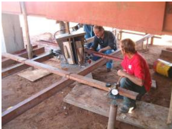
Figura 1 – Ensaio de sapata a tração em solo argiloso.
