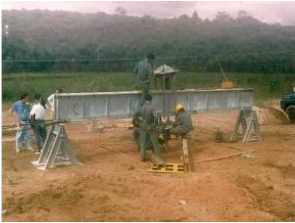
Figura 3 – Ensaio de grelha a tração em solo arenoso.
