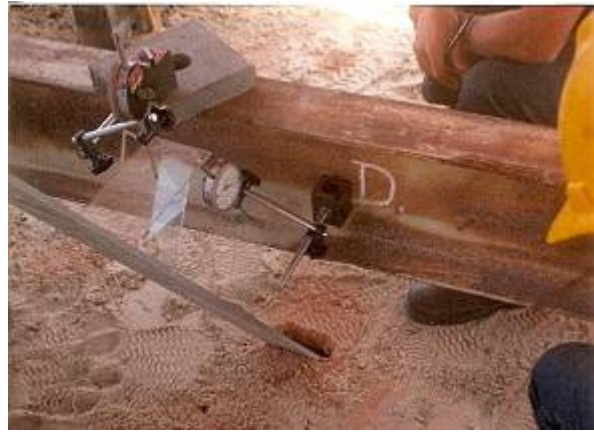
Figura 4 – Ensaio de estai a tração em solo arenoso.
