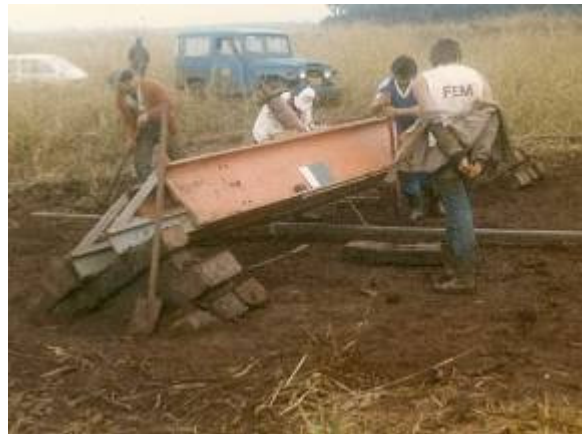
Figura 2 - Ensaio de estai a tração em solo argiloso.
