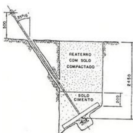
Figura 8 – Fundação de estai com reaterro reforçado.
