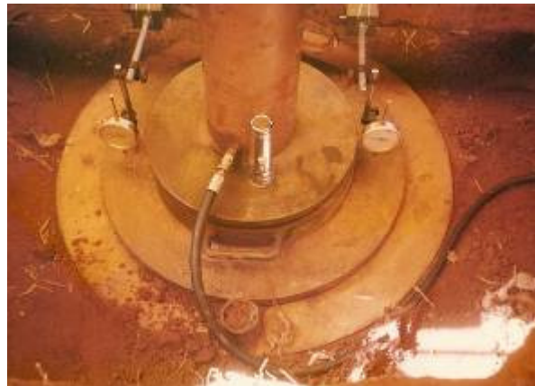
Figura 6 – Ensaio de compressão de placa.
