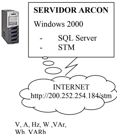
FIGURA 4 - Configuração do Sistema de Telemetria – Lado da Estação Central.
