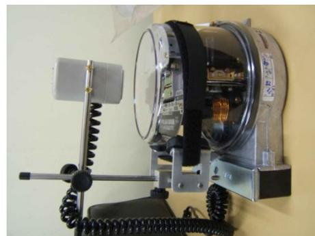
Figura 5. Sensor para Captação de Pulsos em Medidores Instalados.
