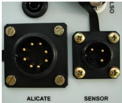
Figura 8. Conector “Melro” para Alicates – vista externa.
