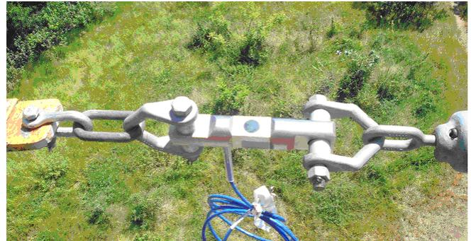
Figura 7. Conjunto de fixação da célula de carga.
