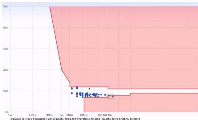
Fig. 5. Curva ITI contendo os VTCDs medidos nos Processos Sensíveis
