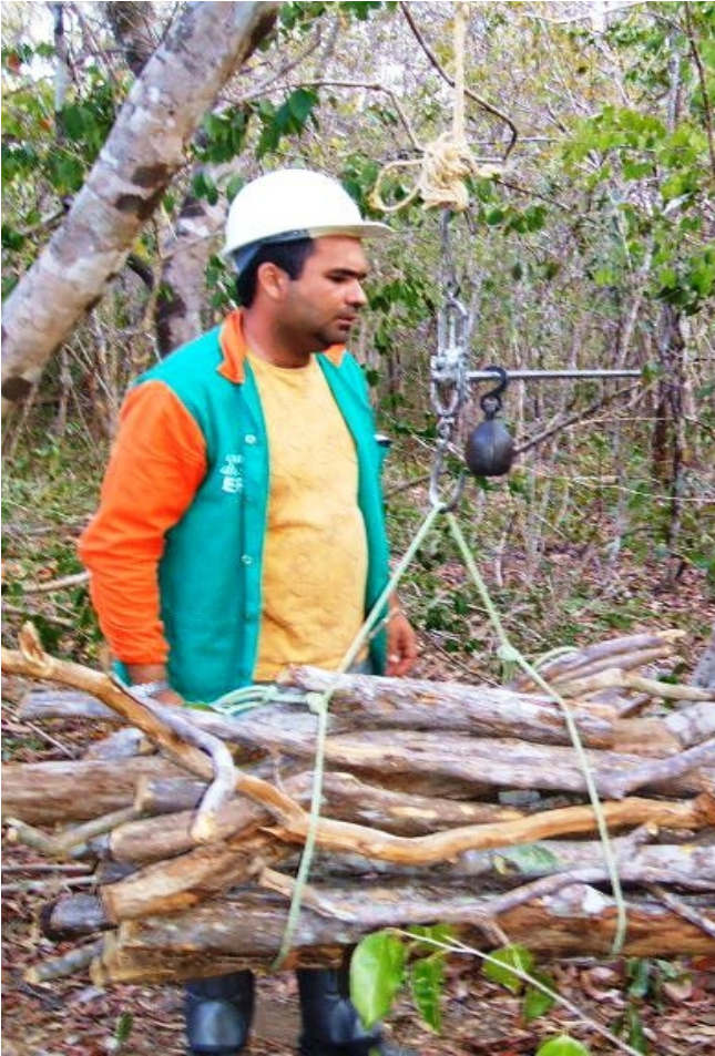
Figura 3. Pesagem da lenha para a determinação da quantidade de massa por unidade de área.
