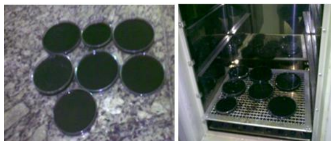
Figura 10. Processo de secagem das microalgas em estufa
