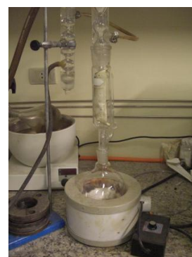
Figura 11. Processo de extração de óleo com o aparelho de Soxhlet
