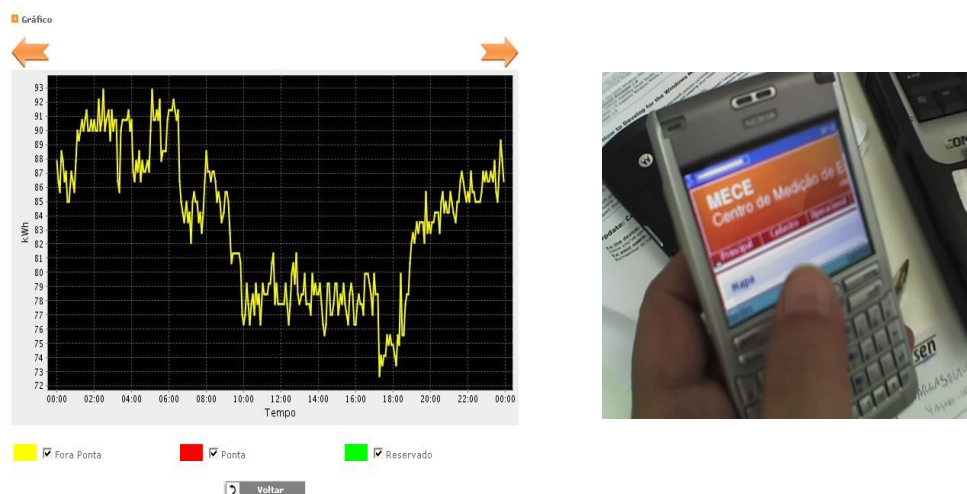
Figura 3 – Curva de carga e acesso ao MECE através de telefone celular GSM/GPRS
