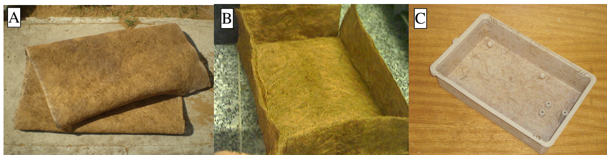
Figura 1- Aspecto físico da manta de fibra de coco nas diferentes etapas da preparação dos compósitos. A) Manta produzida Na COOBCOCO, B) Pré caixa de fibra. C) caixa final compósita.
