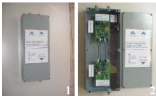
FIGURA 2 - Protótipo do isolador fechado (foto 1) e com a tampa aberta (foto 2).
