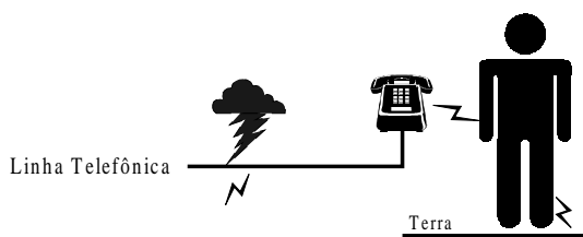
FIGURA 1- surto de modo comum. Surtos na linha telefônica podem caminhar para o solo através do usuário ou equipamento.
