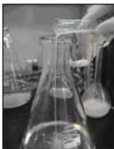
**Figura 1.** Adição do agente biorremediador, Agro Remed, às amostras de água padrão – teste em escala laboratorial.
