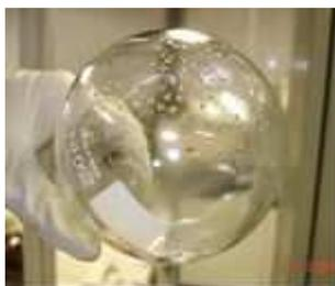
**Figura 6.** Resíduo formado após ação do agente biorremediador sobre amostras de solo isentas de óleo diesel, utilizando o método gravimétrico de determinação de TPH.
