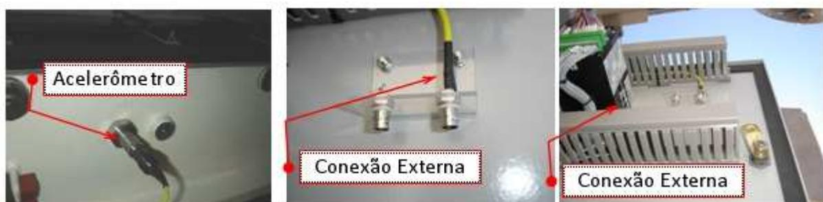
Figura 2 – Conexão do cabo do acelerômetro com a parte externa (Central de Manobra)
