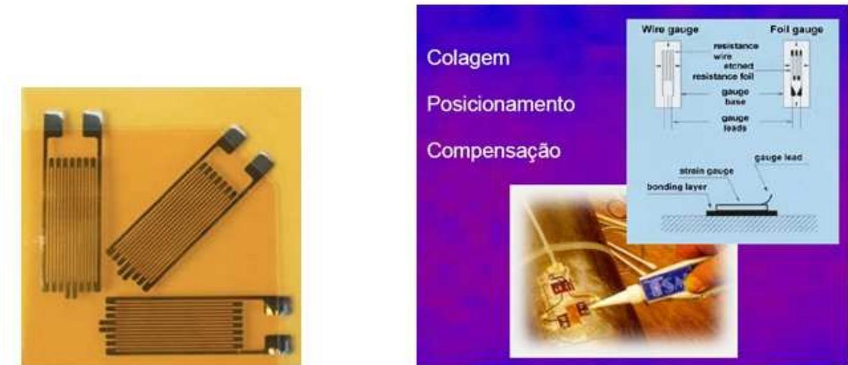
Figura 5 – Exemplo de um extensômetro para a medição em três direções
